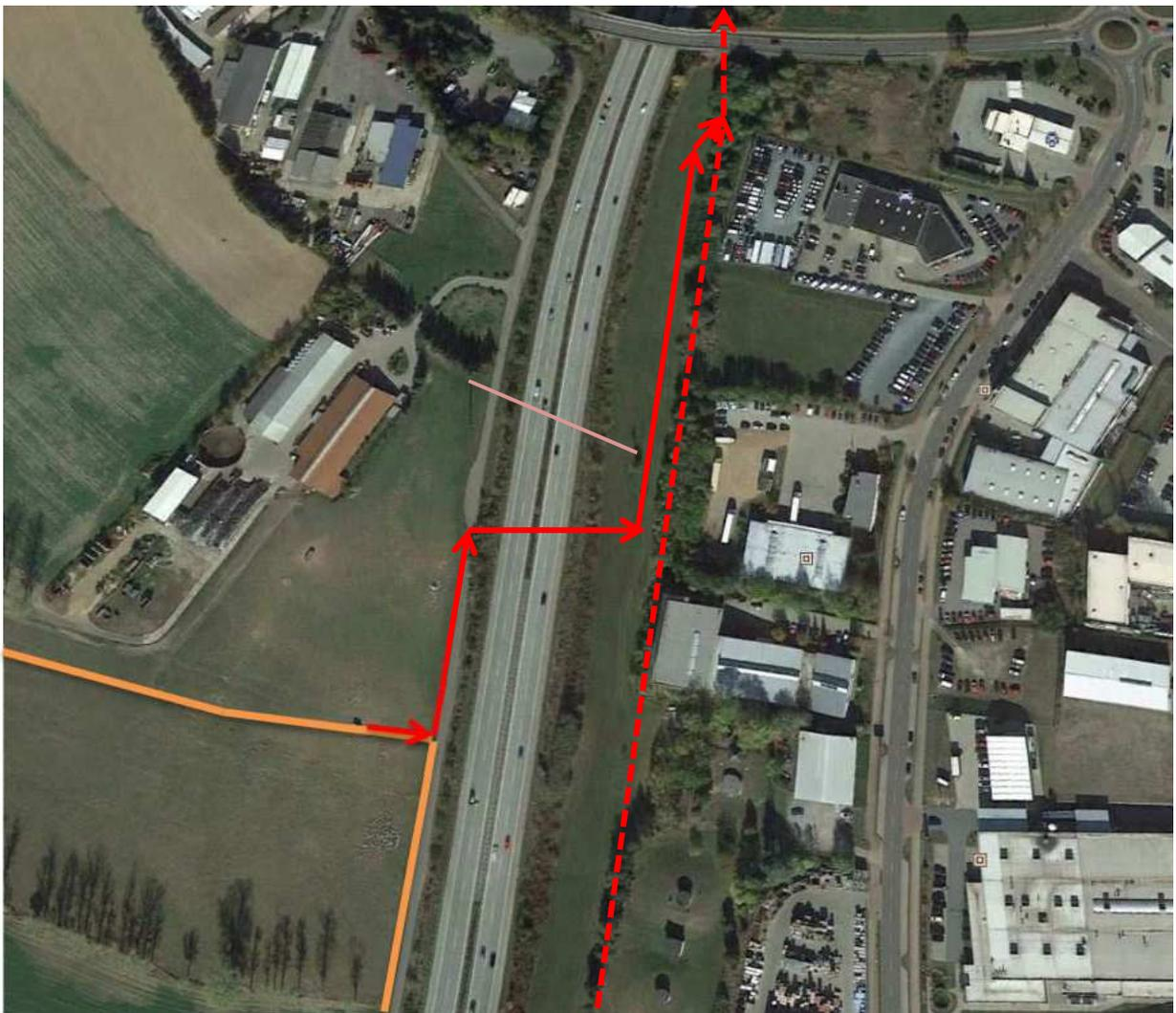
**Abbildung 1: geplantes BG und schematischer Fließweg zum „Autobahnsummler“ mit Querung der A 72 (mit querender Freileitung Elt)**
