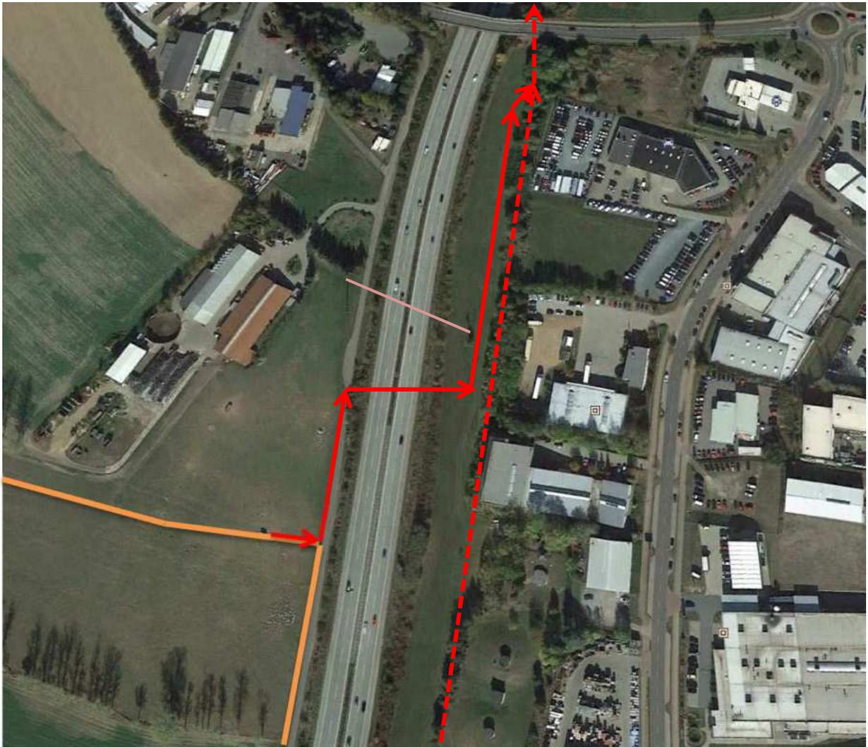
Abbildung 23: geplantes BG und schematischer Fließweg zum „Autobahnsammler“ mit Querung der A 72 (mit querender Freileitung Elt)
