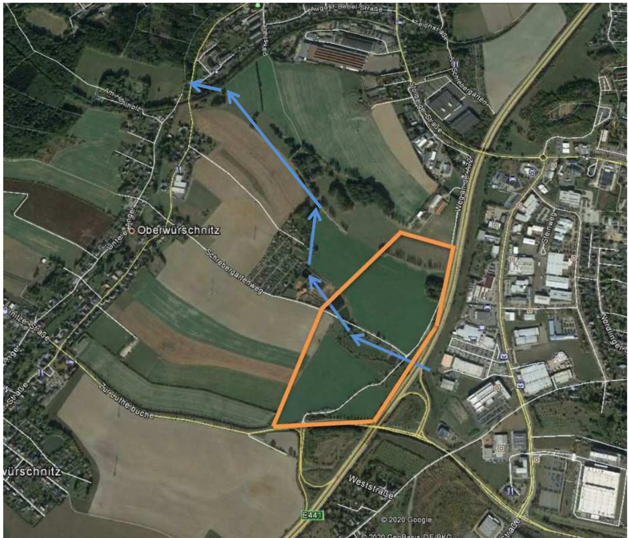
**Abbildung 6: bestehender Fließweg zum Würschnitzbach und geplantes BG (schematisch)**
