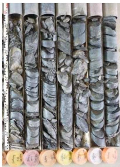
Die Schieferung des Phyllits besitzt hier prinzipiell erzgebirgisches Streichen und fällt laut geologischen Unterlagen mit ca. 20° - 50° nach Nordwest ein. Wie die Bohrkernfotos erkennen lassen, wechselt die Schieferung im Phyllit auf teils kurzer Distanz. Teilweise sind Winkel von 5 bis 50° zur Bohrachse gemessen worden, was für das Lösen von primärer Bedeutung ist.
